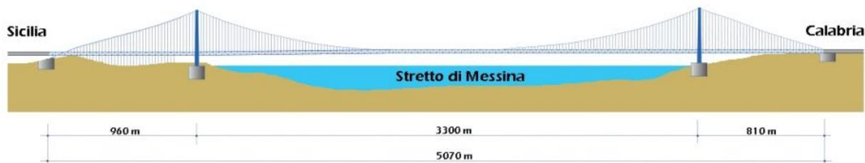
Il progetto di Ponte a campata unica
